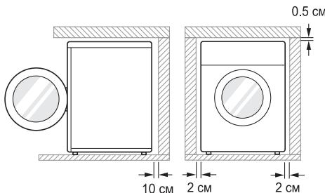
**Ровный пол:** допустимый уклон пола под всей занимаемой машиной площадью не должен превышать 1°.
