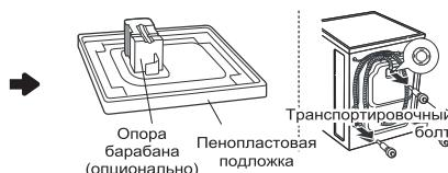
Снимите транспортировочные болты и опоры.
